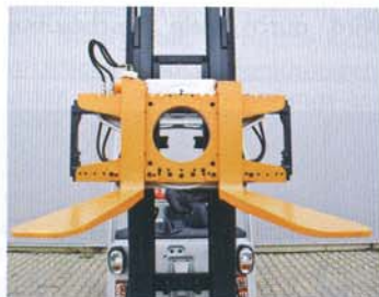
Die offene Bauweise des Drehgeräts sorgt für sehr gute Sichtverhältnisse (Bild: Durwen)
